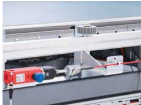
Equipamiento para la conformidad CE: Cuerda de apertura en dirección longitudinal a la cinta de retorno
